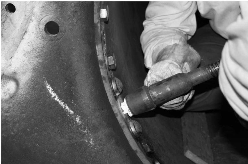
**Nietarbeiten im Kessel der Lok 11.**
