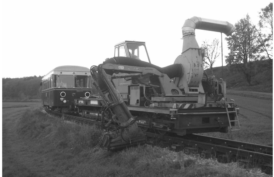
Das Böschungsmähgerät auf Probefahrt. In Bildmitte ist der bewegliche Mähkopf zu sehen. Das Grüngut wird abgesaugt und über das rechts oben sichtbare verstellbare Rohr zur Seite geblasen. Foto: Matthias Esslinger
